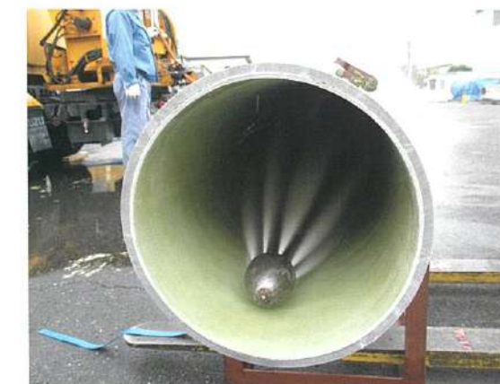
耐高圧洗浄試験
