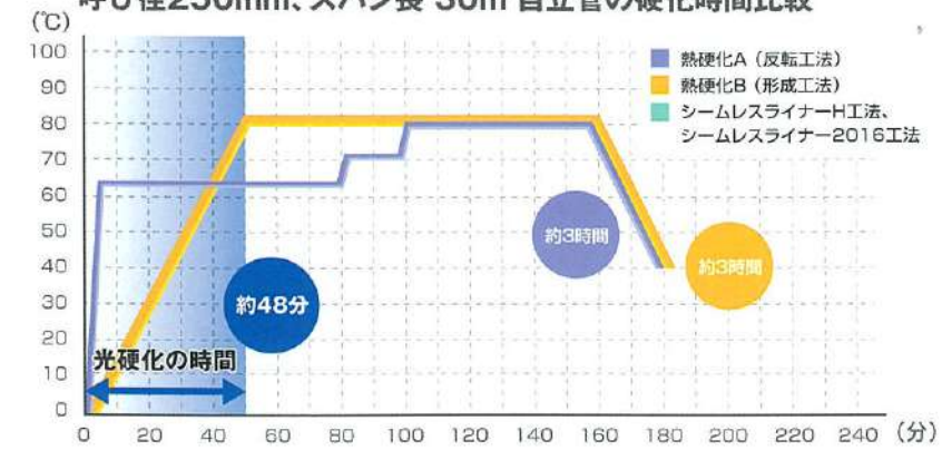
呼び径250mm、スパン長 30m 自立管の硬化時間比較
