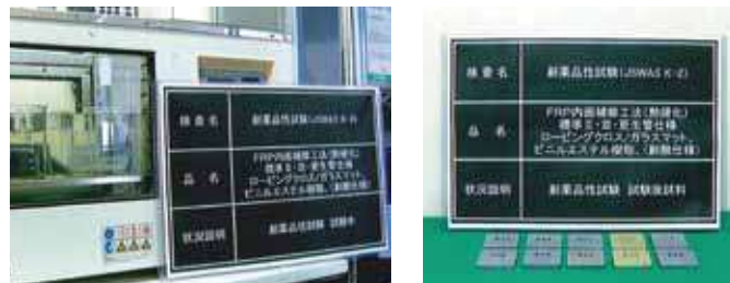
耐薬品性試験-熱硬化(JSWAS K-2) 状況
