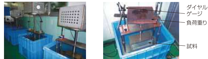
曲げ試験-φ250(JIS K 7039) 状況
