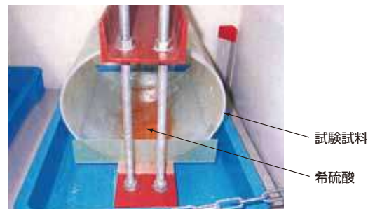
耐薬品性試験(JIS K 7034) 状況
